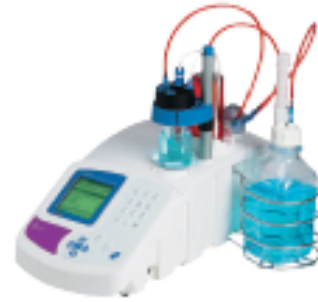
Fig. 4: Valorador TIM 84Q de HACH LANGE para la determinación de FOS/TAC, pH y potencial redox.
