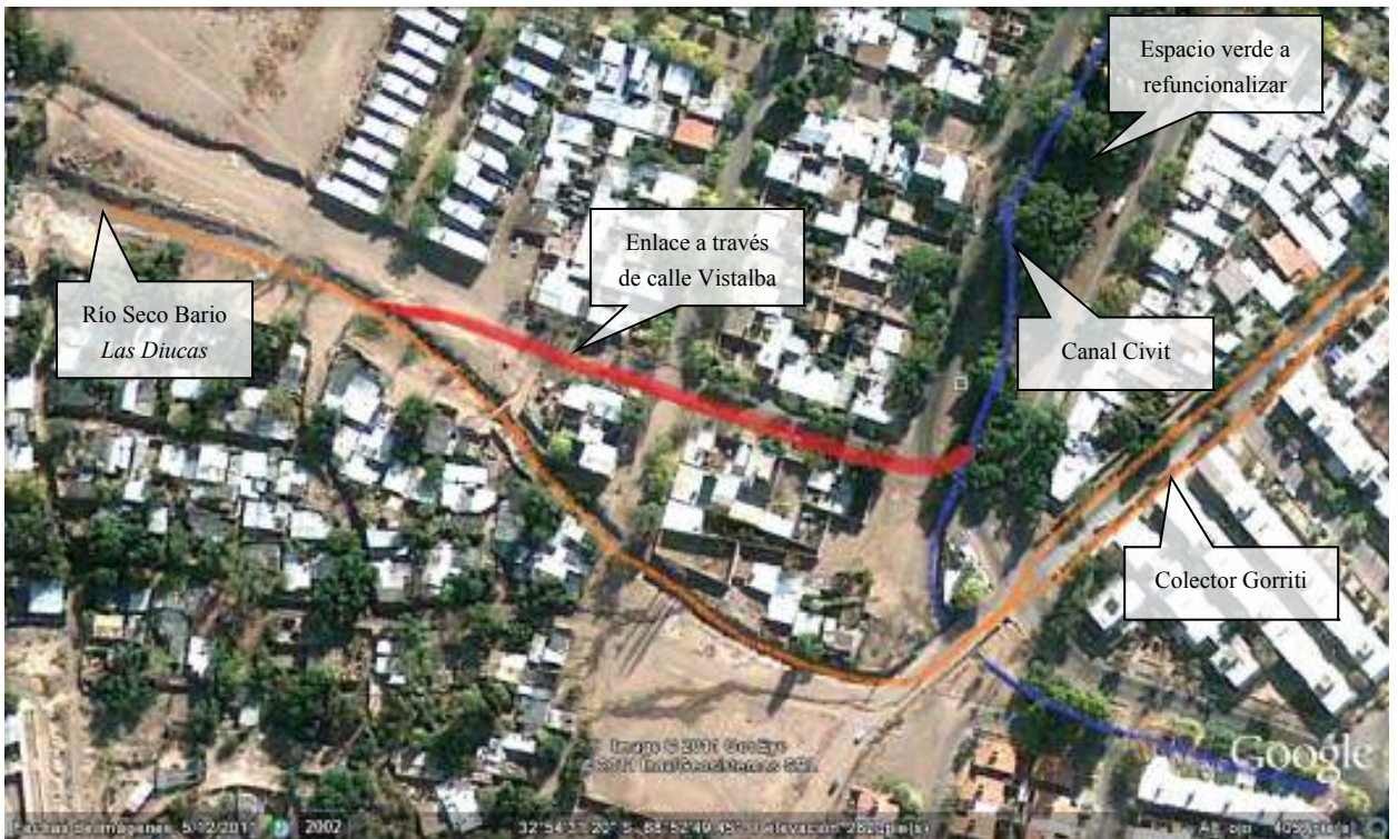
Figura 338: Traza del enlace del Río Seco del Barrio Las Diucas con el Canal del Oeste, suprimiendo su aporte al Colector Gorríti.
