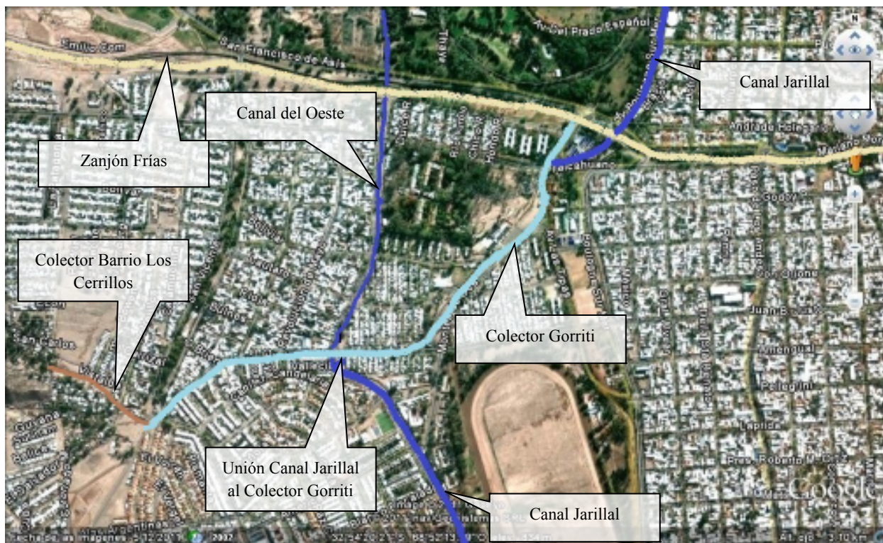
Figura 313: Traza del Colector Gorriti, del Canal Jarillal y del Canal del Oeste.
