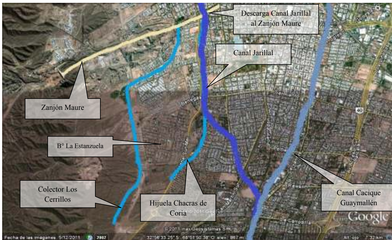
Figura 294: Desarrollo del Colector Hijuela Chacras de Coria en el Oeste de Godoy Cruz hasta la desembocadura en el Canal Jarillal.
