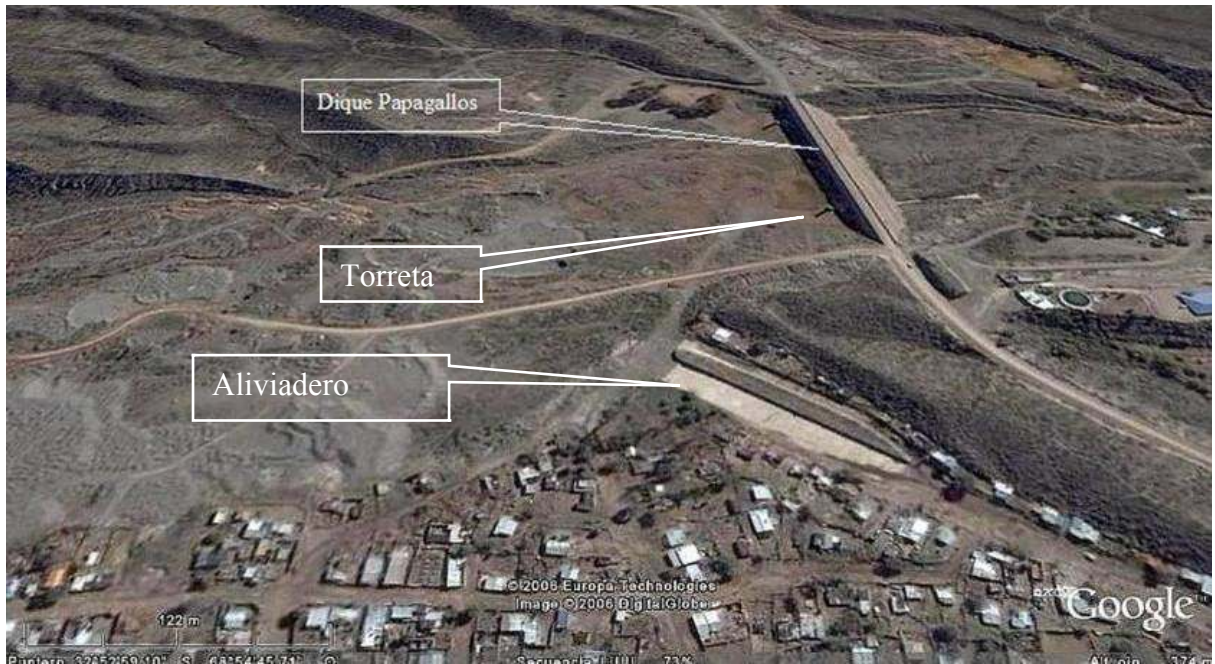
Figura 57: Imagen completa del Sistema del Dique Papagallos. Pueden observarse el crecimiento de una villa inestable que rodea el canal de evacuación del Aliviadero.
