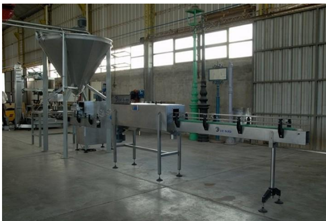
Figura 5.16. Envasadora a pistón múltiple cabezal.
