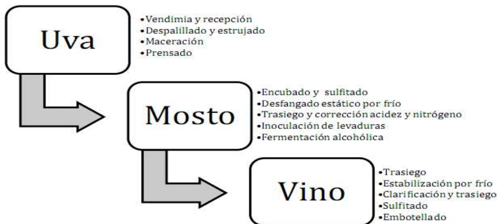
Fig.2. Diagrama de flujo del proceso de vinificación realizado
