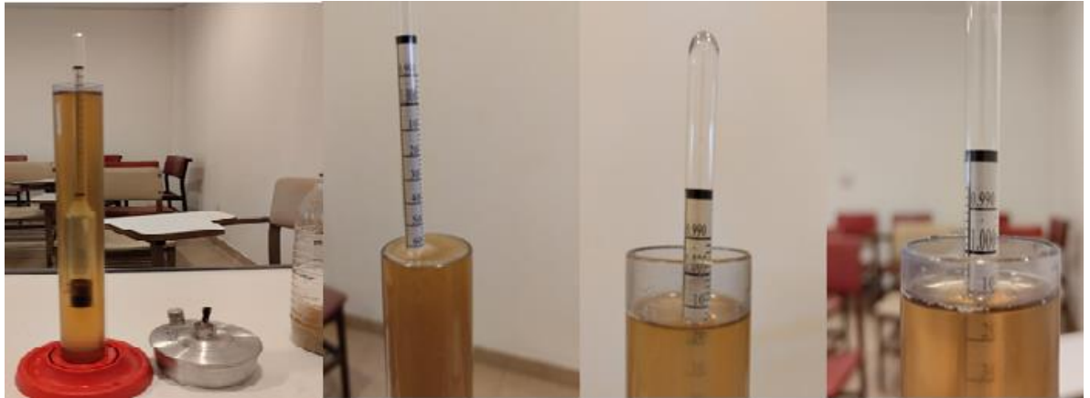
Figura 20: Uso de densímetro en la medición de la evolución del descenso de densidad en el mosto
