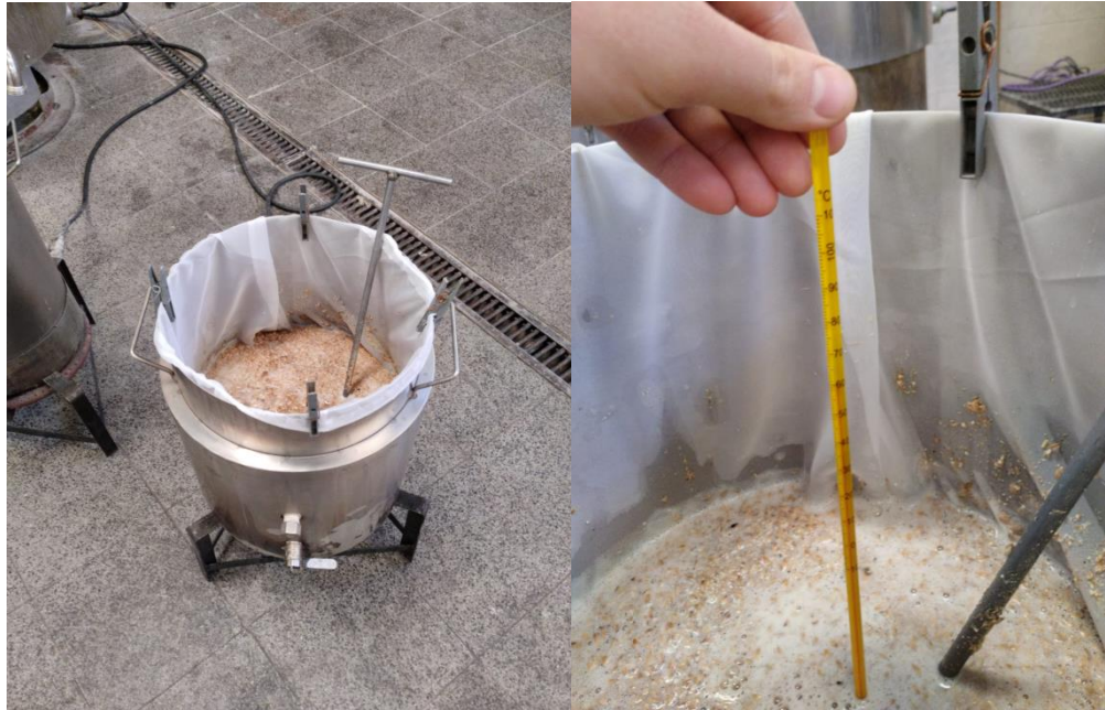
Figura 6: Fase de maceración y control de su temperatura fuente
