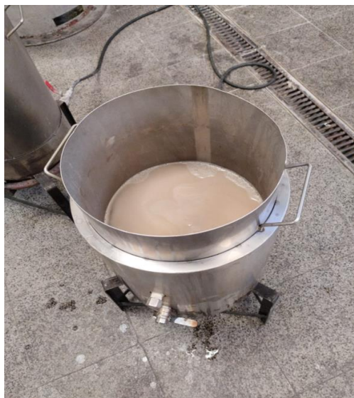
Figura 8: Fase de cocción y lupulado
