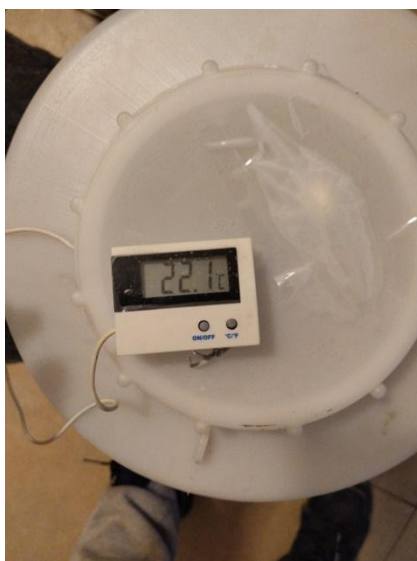
Figura 10: Control de la temperatura en la fase de refrigeración del mosto.
