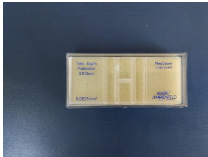
Figura 26: Cámara de Neubauer utilizada para los recuentos de levaduras
