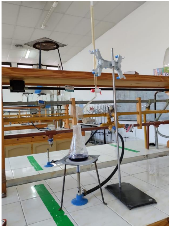
Figura 21: Determinación de azúcares reductores residuales por método Fehling Cause Bonnans
