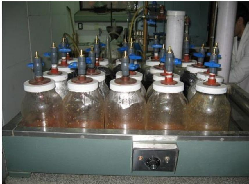
**Figura 3: Disposición de reactores de PET en baño termostático.**
