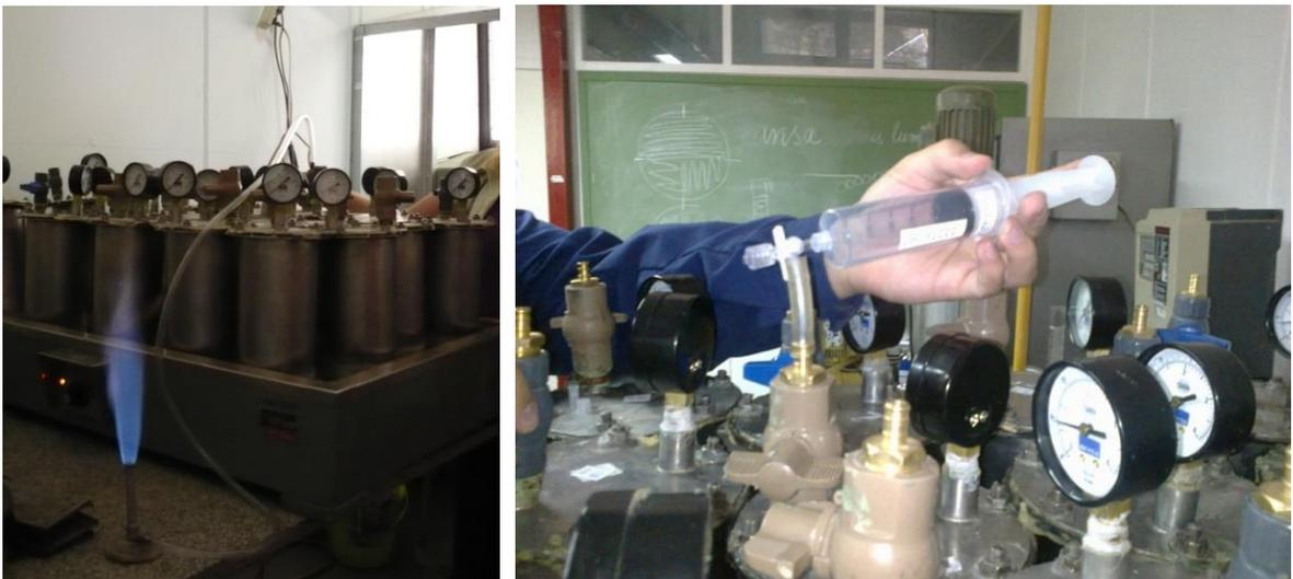
**Figura 7: reactores en baño termostatzado (izquierda) y toma de muestra de gas en jeringa (derecha)**
