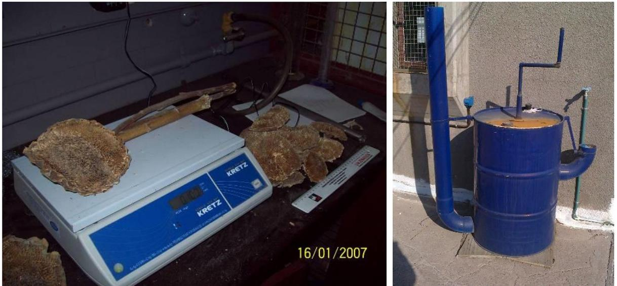
**Figura 4: Caracterización de residuos de cultivos energéticos. Reactor anaeróbico de 200L provisto de sensores para control de temperatura presión y pH.**
