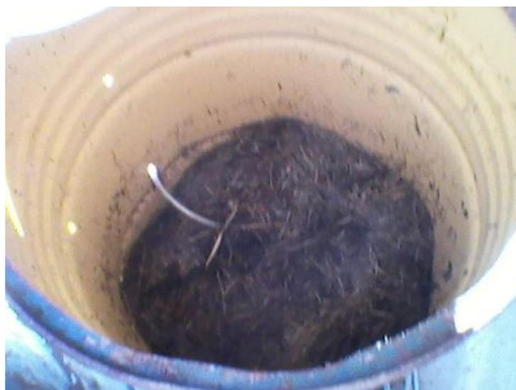
**Foto 9: Disposición de los residuos en capa en reactor (compostaje mecánico).**
