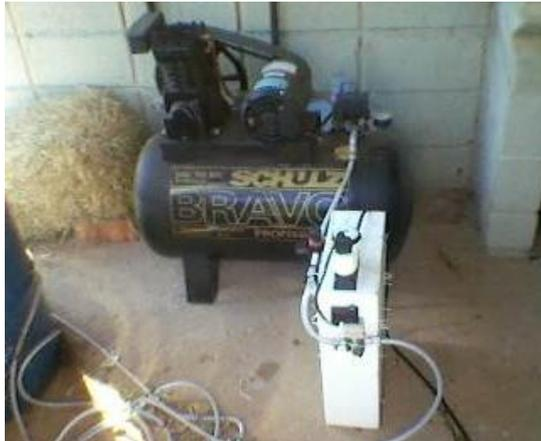
**Foto 8: Compresor de aire utilizado en el compostaje mecánico.**
