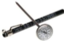
El uso de este termómetro es muy común; pero es muy difícil obtener una temperatura correcta ya que es muy lento para medir la temperatura del alimento. La zona que mide esta a un par de pulgadas mas arriba de la punta, en una área donde hay un pequeño hueco. Esto significa que este termómetro en particular no se puede usar para tomar la temperatura de alimentos delgados.
