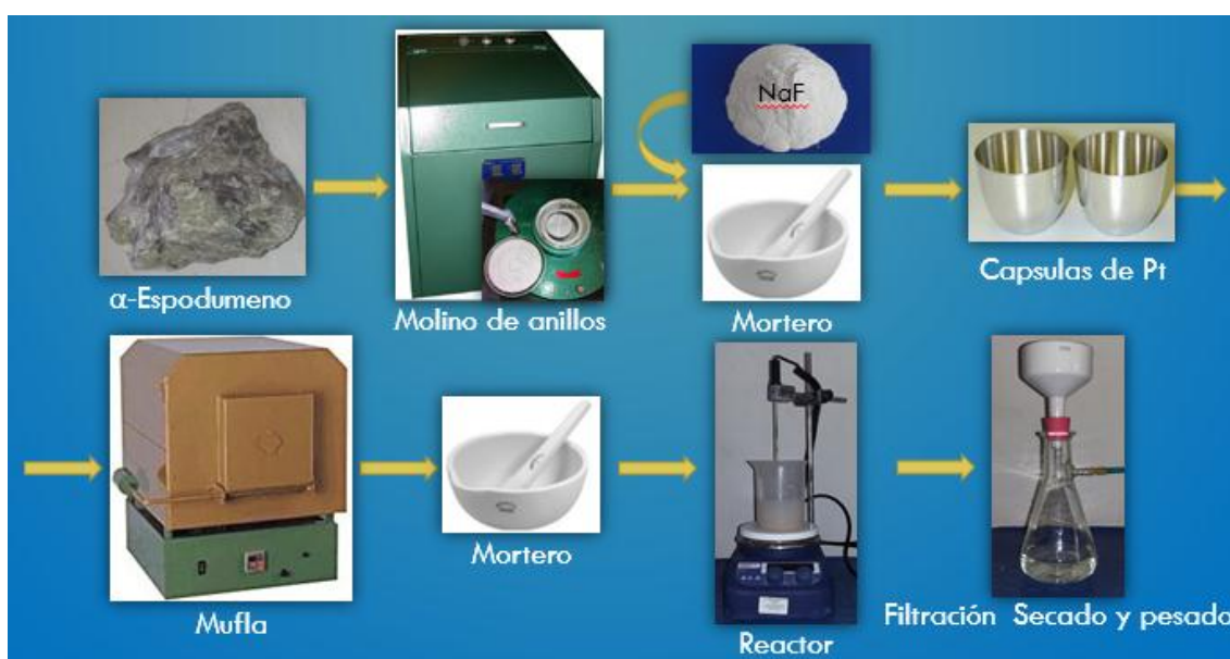
Figura 3.3.1. Esquema del procedimiento experimental para el sistema \alpha -espodumeno/NaF
