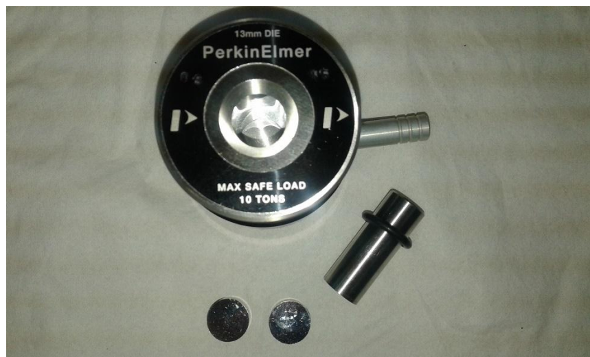
Figura 2.3. Pastillero Perkin Elmer de 13 mm de diámetro interno.
