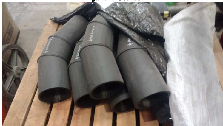
Figura 8. Accesorios de tuberías Pead.
