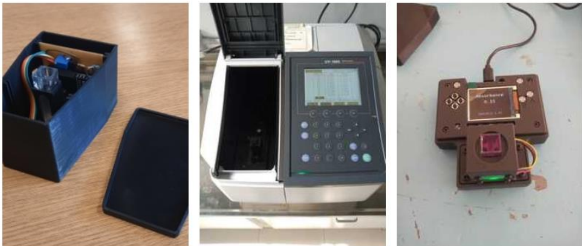
Figura 4: Lado izquierdo: Colorímetro FCEN. Centro: espectrofotómetro Shimadzu UV-Vis 1800. Lado derecho: Colorímetro IO Rodeo.
